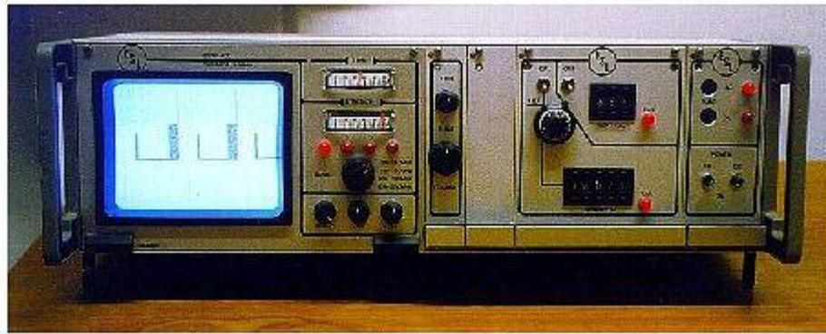
**Рисунок 2.** DataSafe/ESL Model 400 - монитор Темпест-излучений
